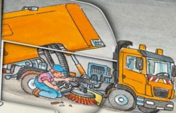
Die Besen derkehrmaschine werden ausgetauscht.
