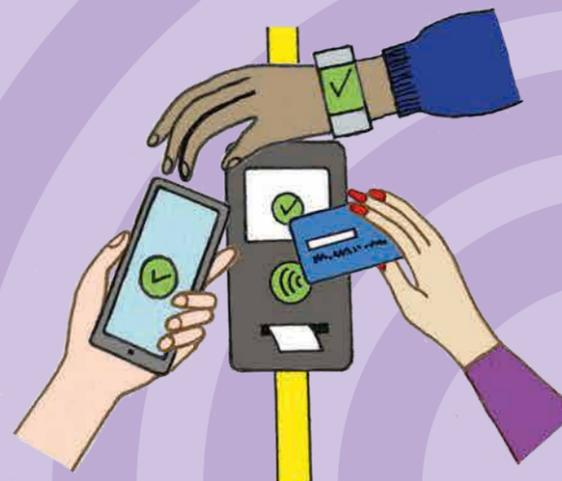
**NFC** (Near Field Communication) ist ein kontaktloser Datentransfer zwischen Mo- biltelefonen und Karten mit speziellen Mikrochips und wird für digitale Tickets, Zahlungen und vieles mehr verwendet.
