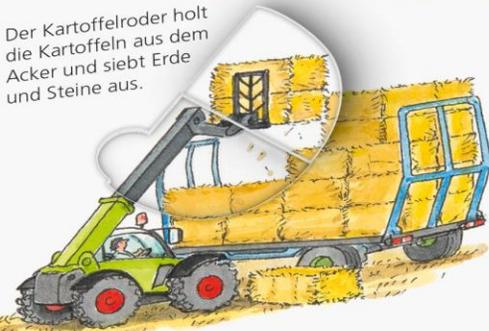
Das Stroh, das der Mährescher auf dem Feld zurücklässt, wird zu festen Ballen gepresst. Die lassen sich gut stapeln. Der Teleskoplader hebt mit seinem ausfahrbaren Arm die Ballen zum Transport auf den Ladewagen.
