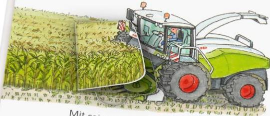
Mit seinen scharfen Messern schneidet der Maishäcksler mehrere Reihen Mais gleichzeitig ab und zerkleinert sie.
