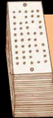
Löcher und „Nicht-Löcher“ einer Lochkarte programmieren einen Computer mit den 1en und 0en der Binärsprache.
