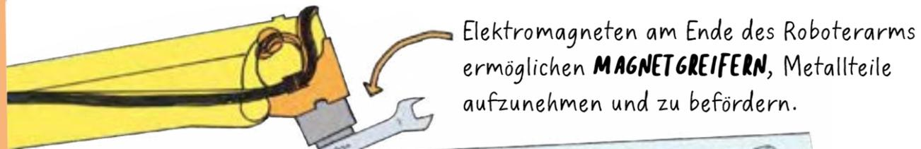
Elektromagneten am Ende des Roboterarms ermöglichen **MAGNETGREIFERN**, Metallteile aufzunehmen und zu befördern.
