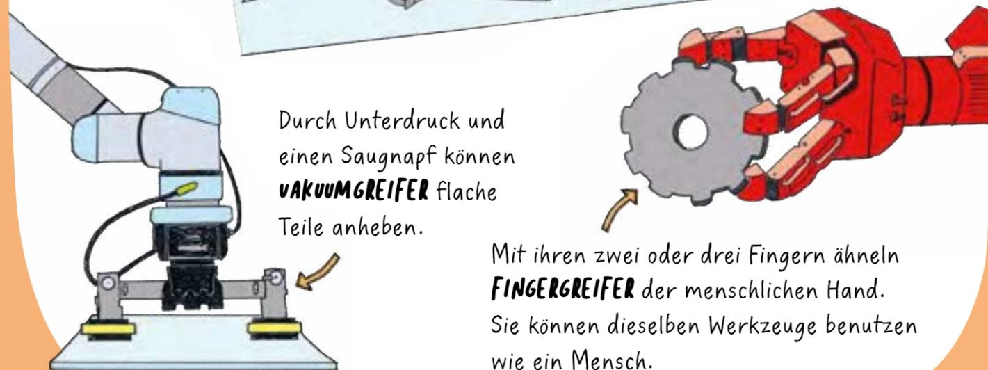
Durch Unterdruck und einen Saugnapf können **VAKUUMGREIFER** flache Teile anheben.
