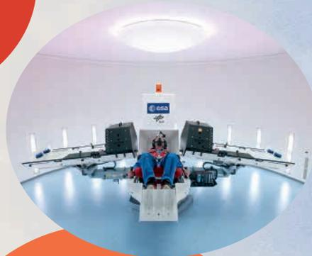
Wie sich die Beschleunigung beim Start der Rakete anfühlt, probieren Astronauten in Geräten wie dieser Zentrifuge aus. Der liegende Astronaut wird darin bis zu 45-mal in der Minute im Kreis herumgeschleudert und wie in einem Karussell nach außen gedrückt – nur viel stärker.
