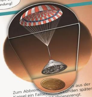
Zum Abbremsen aus der Kapsel ein Fallschirm. Sekunden später wird der Hitzeschild abgesprengt.
